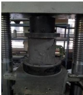
Figura 1 – Cubo de concreto submetido à compressão (Civil Engg. Saminar, 2016)
